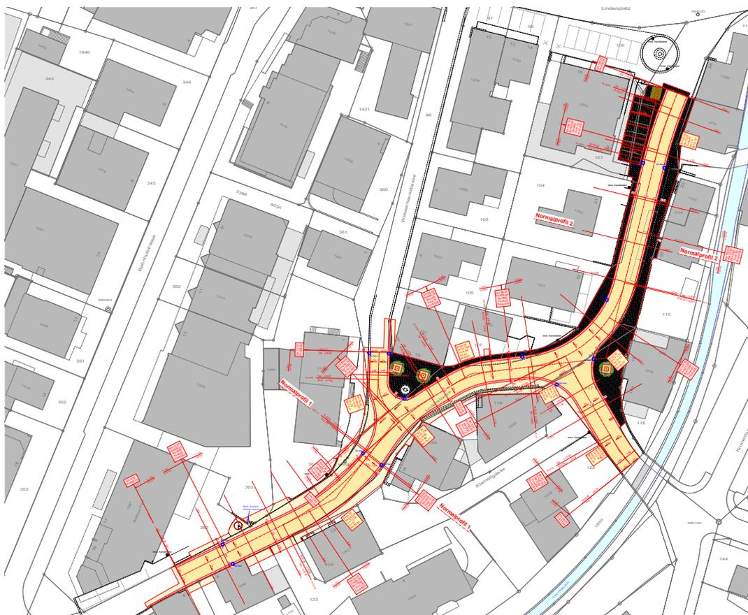
Situationsplan Sanierung (Schwarze Bereiche werden in Pflasterung ausgeführt.)
